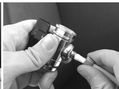
Schlauch über Nippel schieben (Tipp: Schlauchende in heißes Wasser halten, dann wird der Schlauch weicher und lässt sich einfacher montieren)
