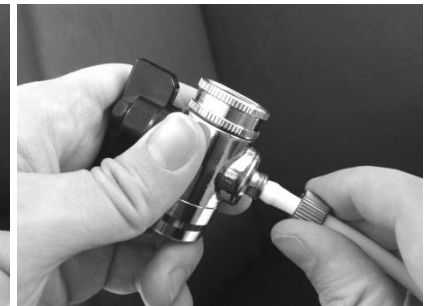
Schlauch über Nippel schieben
